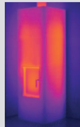
12 hod. od zatopení Průměrná teplota povrchu 45 °C
