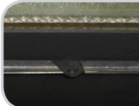
Ovládání spalovacího vzduchu „studenou rukou“ (prodloužená regulační páčka je ke krbové vložce přiložena při dodávce) nastavit doprava. (maximální přívod vzduchu)
